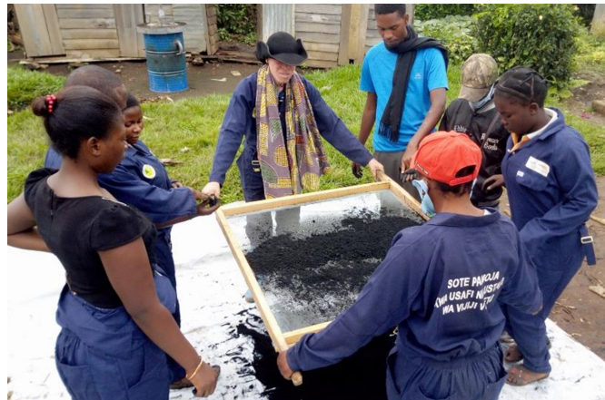
La fabrication du charbon vert : opération de tamisage
