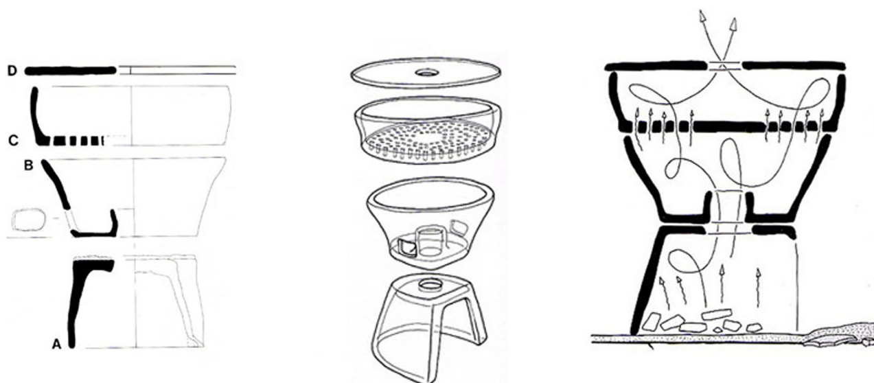
Fig. 4 – Schéma de montage des fours de Martigues. (J. Chausserie Laprée d'après Domallain).
