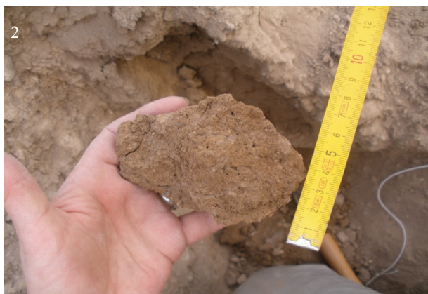
Fig. 8 – 1 : imbrication de pains de terre crue liée au modelage ; 2 : coupe transversale d'un pain de terre ; assemblage de boulettes lié au modelage du pain de terre (photo J. Wattez).
