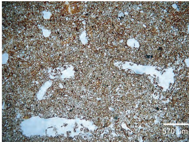
a. Sol construit (phase II) : matrice limoneuse à argilanes oranges finement mélangées, abondantes cavités d'origine végétale (MPOL, LPNA)
