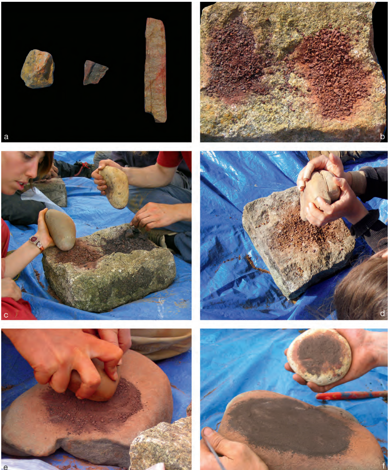
Figure 175 : Tests de concassage et broyage de minerais et hématites : a, qualités A, B et C; b, produit du concassage des matériaux A et C; c, concassage des qualités A et C à l'aide de marteaux oblongs 11 et 12; d, concassage à l'aide du marteau 8; e, broyage longitudinal à l'aide du broyeur 10; f, broyage circulaire avec le broyeur 13.
