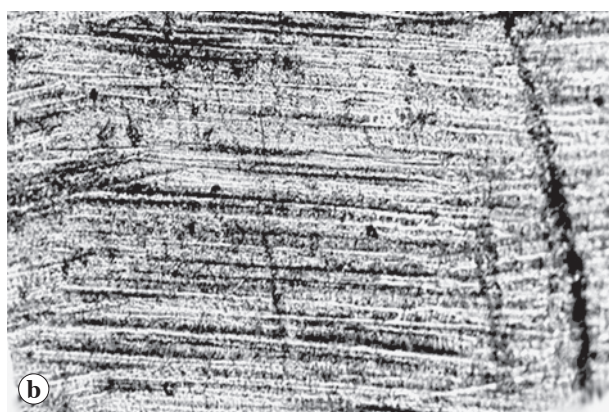
Fig. 9 – Abrasion à l'aide d'une meule à grains fins (a) et stigmates en vue microscopique (b).
