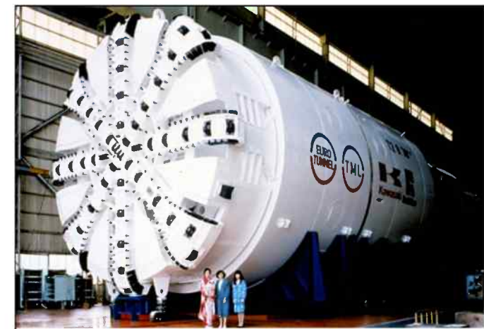
Tunnelier Kawasaki pour le tunnel ferroviaire
