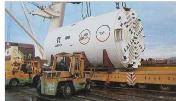
Tunnelier Robins pour le tunnel de sécurité et de service
