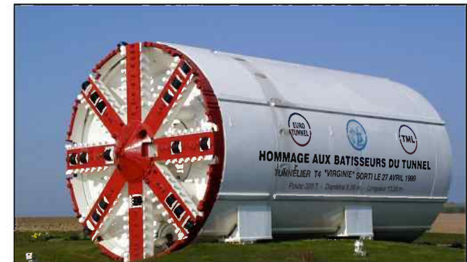
Tunnelier Mitsubishi pour le tunnel de service et de sécurité
